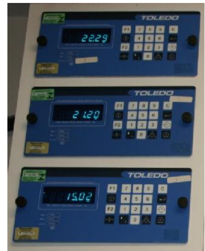
Figura 7: Painéis eletrônico dispostos na parte interna do laboratório, indicando os pesos das balanças que encontram-se localizadas no apiário .
